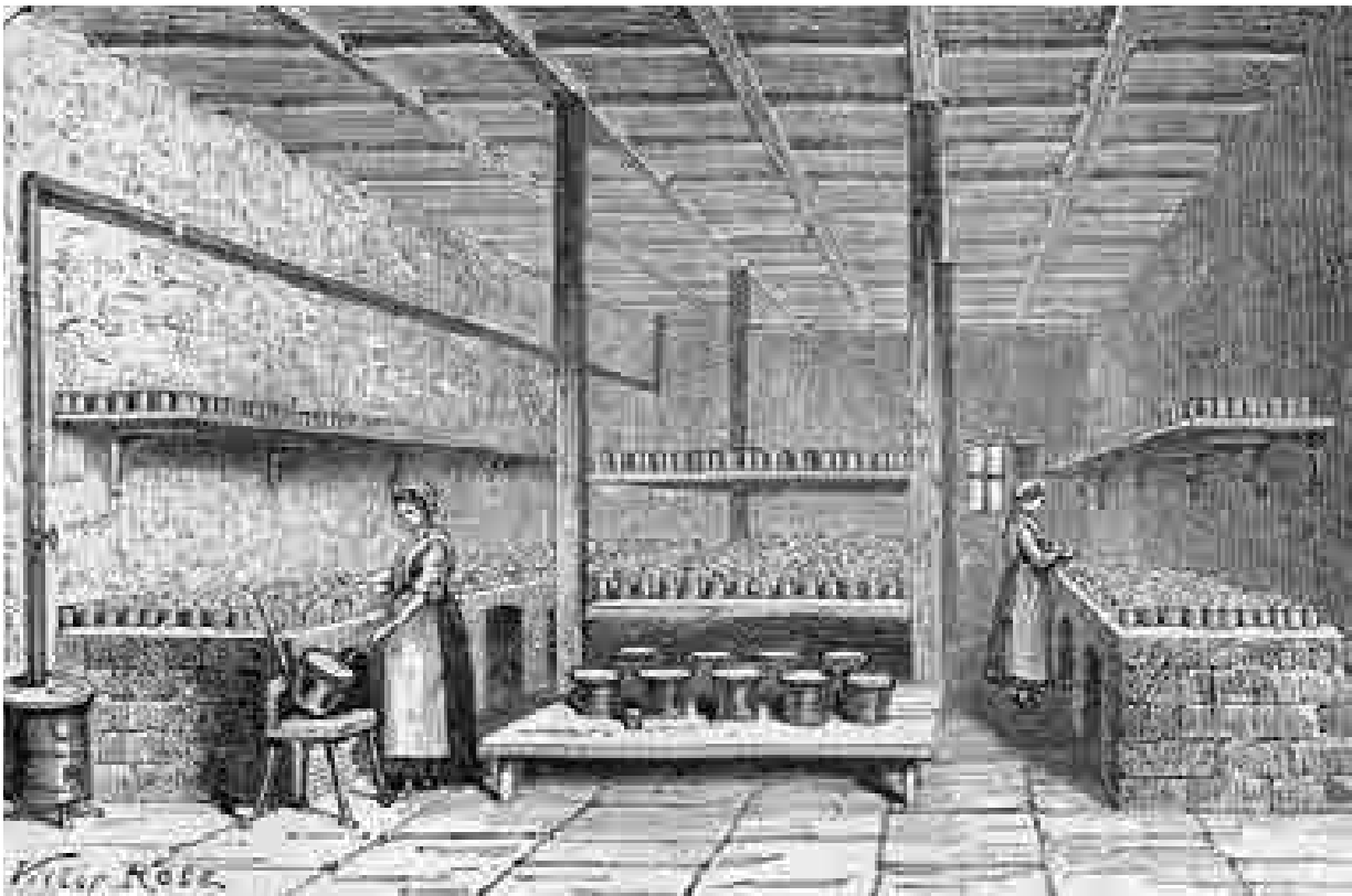
Coulage du lait, mise en présure et remplissage des moules dans une fromagerie de Camembert, gravure de Victor Rose, Annuaire normand, 1878 © BnF.
