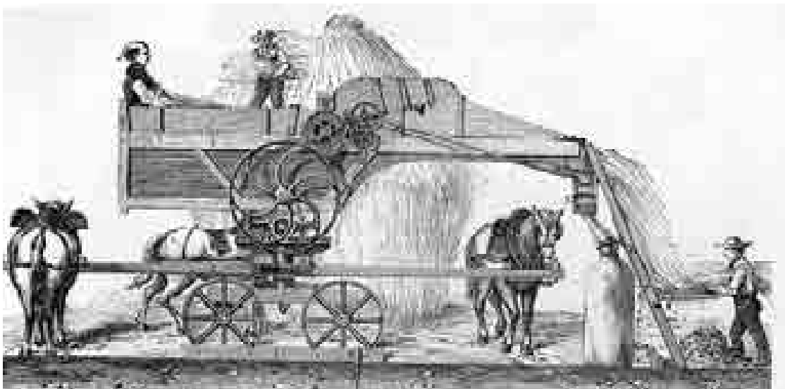
Batteuse Damey à manège, E.-O. Lami, Dictionnaire encyclopédique et biographique de l'industrie et des arts industriels , Paris, 1881, vol. 1 © BnF.
